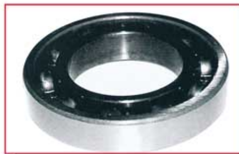
被乙炔喷枪加热后的轴承，表面变成黑色
