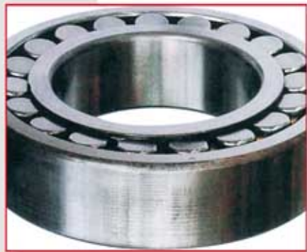
壳体孔径与轴承外径表面之间产生滑动的痕迹
