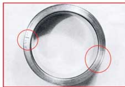
内圈端面与轴肩摩擦发热产生裂纹
