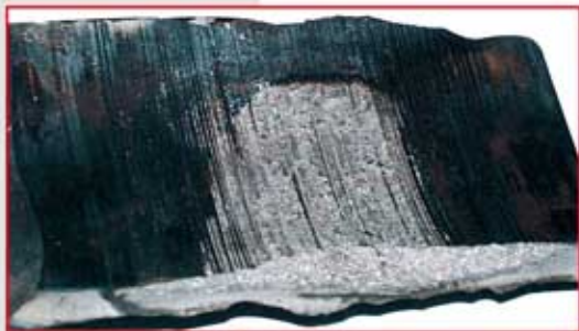
轴与内孔表面之间发热后产生的粘连
